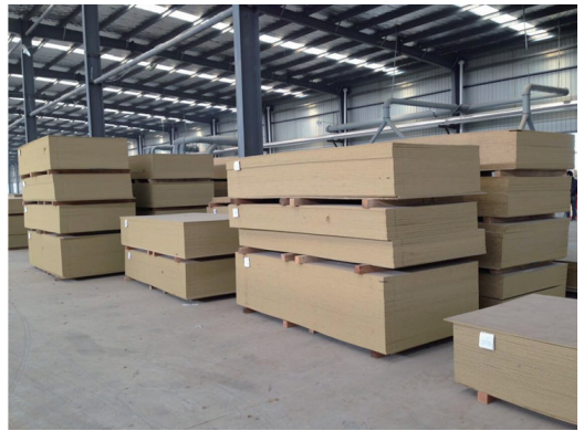
图3 绿色防火农林剩余物无机复合材
