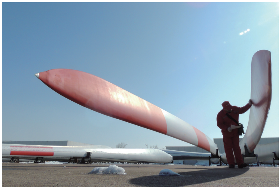
图4 碳纤维复合材料大型风电叶片(图片来源:新华社 耿玉和 摄)
