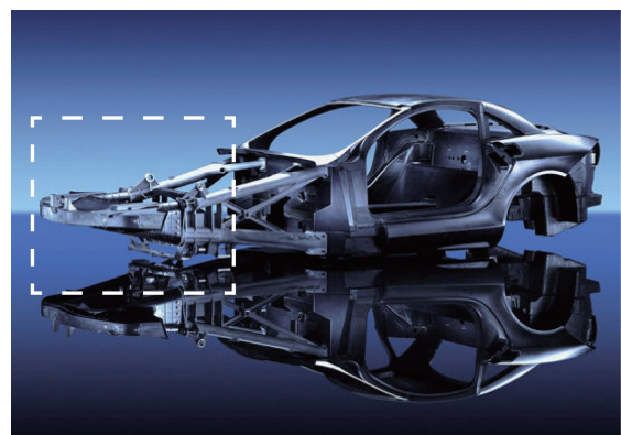
图2 奔驰SLR McLaren车型的CFRP溃缩柱
