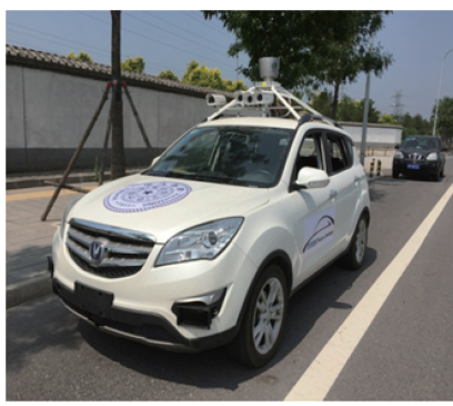
清华大学第三代全线控试验样车 THU-IV3 (2015—2016) (图片来源: 邓志东)
