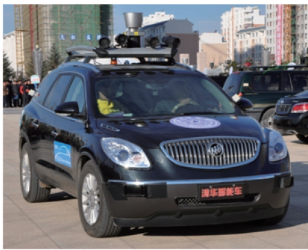
清华大学第二代试验样车 THU-IV2 (2011—2014) (图片来源: 邓志东)
