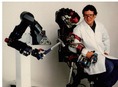
图7 美国Utah大学研制的外骨架同构式力反馈手控器
