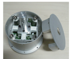
(a) 典型的十字梁结构 (b) 东南大学的六维力传感器结构 (c) 东南大学研制的六维力传感器
