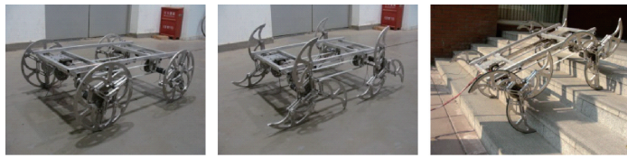
(a) 圆轮 (b) 异形轮 (c) 结构化路面试验
