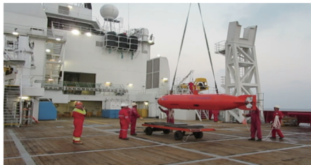
图10 2000 m海洋探测智能水下机器人南海试验
