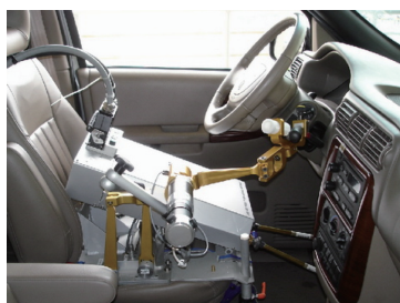
图2 德国STAHLE公司驾驶机器人 Fig. 2 Driving robot of German STAHLE Company
