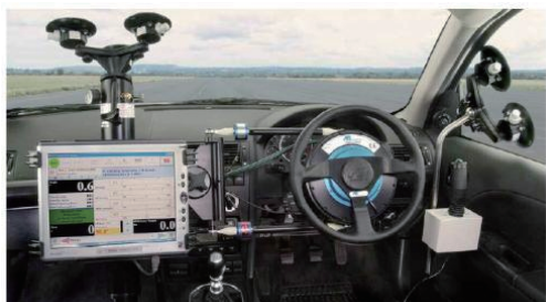
图1 英国ABD公司转向机器人 Fig. 1 Steering robot of British ABD Company
