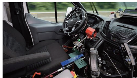
图3 福特耐久性测试驾驶机器人 Fig. 3 Driving robot for durability test of Ford
