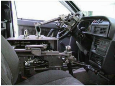
图4 东南大学DNC-2驾驶机器人 Fig. 4 DNC-2 robotic driver of Southeast University
