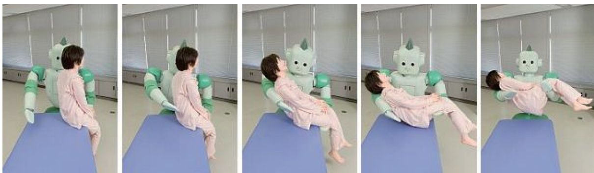
图9 RI-MAN成功地按照使用者的语言指令,安全实现对被护理人员的移乘护理工作
