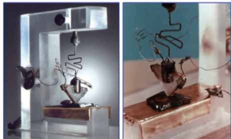
图5 第一只晶体管的实验装置
