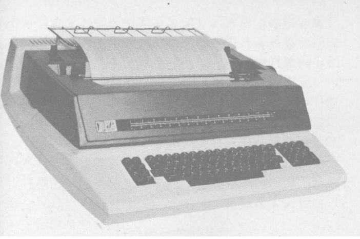
图5 电传打字机 / 打印机 (electric typewriter / printer) 可作输入 / 输出设备
