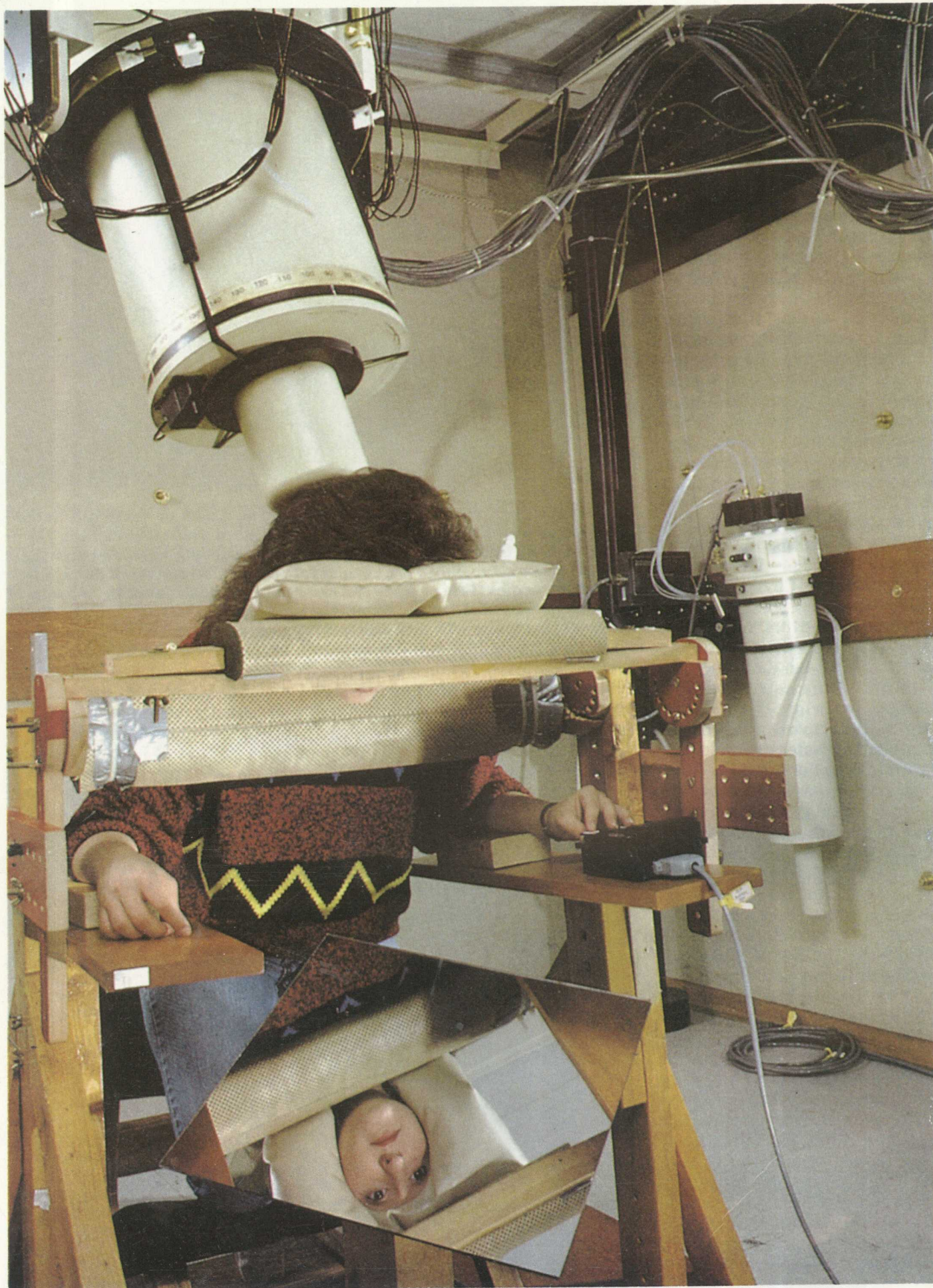
磁脑照相检测仪：在白色圆柱体内的超导量子干涉器件紧靠一位女士的后脑，由其脑电活动感应出检测磁场。
