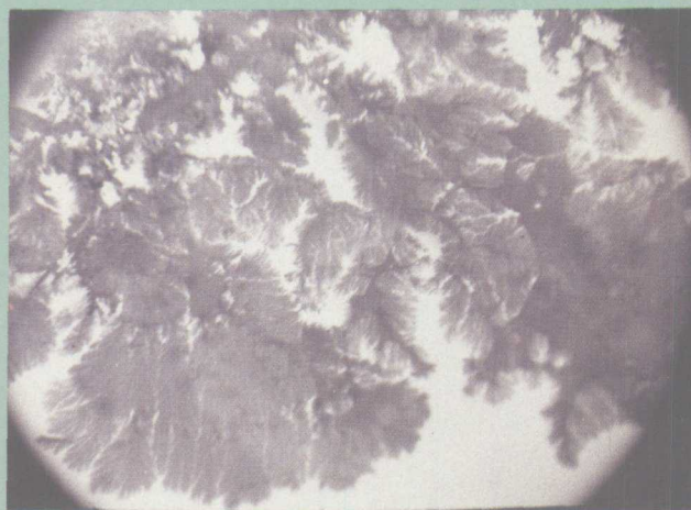
下图: 用液晶(T15)作为界面L-B膜材料, 在生长1小时后拍摄的, 恒电流从 1\mu\text{A} \sim 0.5\text{mA} 。
