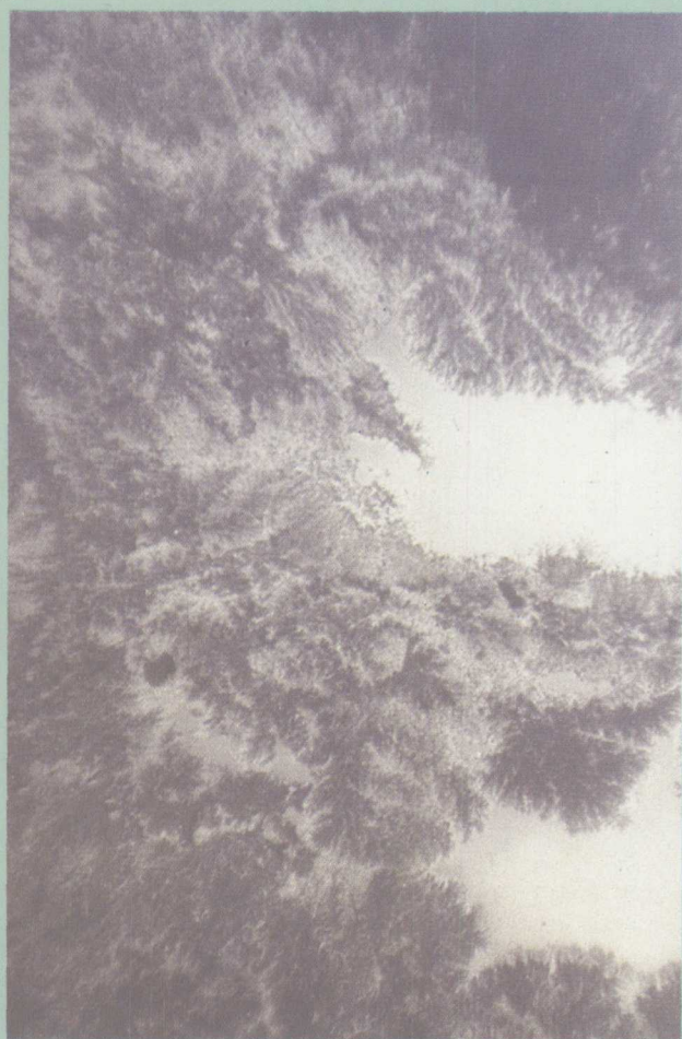
上图: 用花生酸作为界面L-B膜材料, 在一定表面压力下生长成的银膜, 转移到载波片上后拍摄的, 放大约100倍。右为局部图, 放大约10倍。
