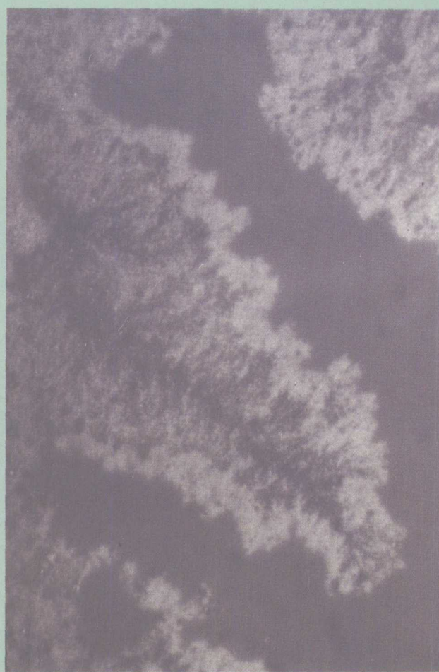
上图: 用花生酸作为界面L-B膜材料, 在一定表面压力下生长成的银膜, 转移到载波片上后拍摄的, 放大约100倍。右为局部图, 放大约10倍。
