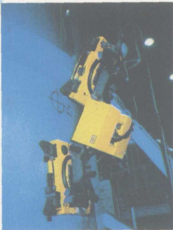
4 日本高级机器人计划中的爬壁机器人
