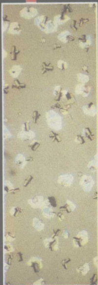
通过蒸发 C 60 苯溶液得到的富勒氏球晶体. C 60 苯溶液中含有大量的 C 70 杂质
