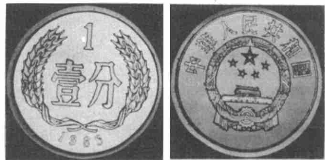
图3 壹分硬币表面的超声 C 扫图像
