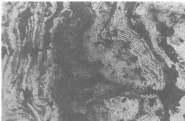
图4 锰结核纹层状构造(显微镜光片)
