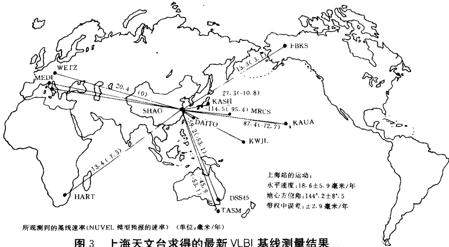
图 3 上海天文台求得的最新 VLBI 基线测量结果
