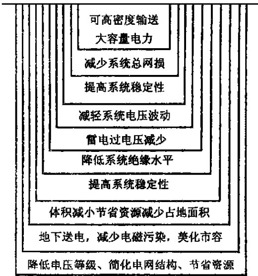
图 2 电力系统中应用超导技术的优越性
