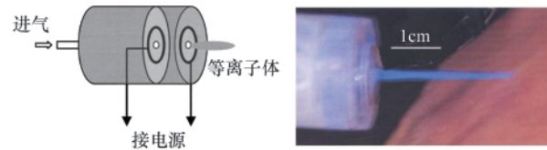
图 9 等离子体喷流装置结构示意图以及与人皮肤相接触的照片
