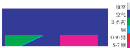
图 1 聚能装药二维计算材料模型图
