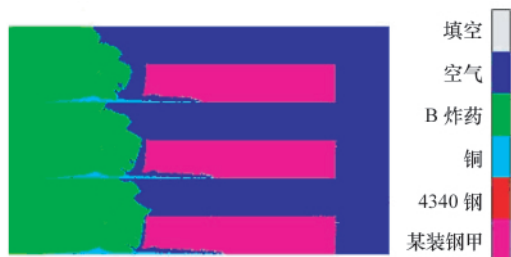
图 6 射流对某装甲钢靶板侵彻数值模拟
