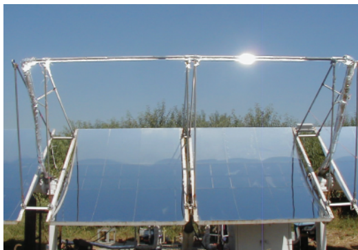
图5 北京通州 5kW 太阳能热化学反应器试验装置
