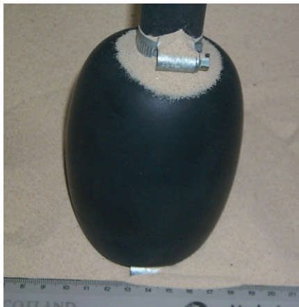
图 2 充气锚杆实物图
