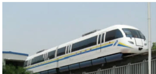
图 6 实用型中低速磁悬浮列车运行在国家中低速磁浮交通试验示范线上(图片来源:李佳伦)
