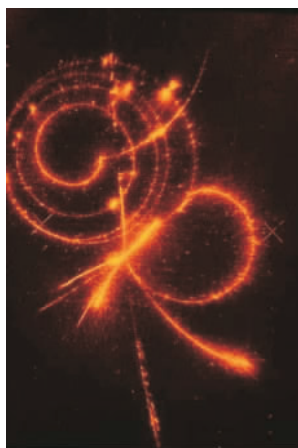
用鲍威尔光学方法拍摄的 离子-介子-电子衰变链试验照片
