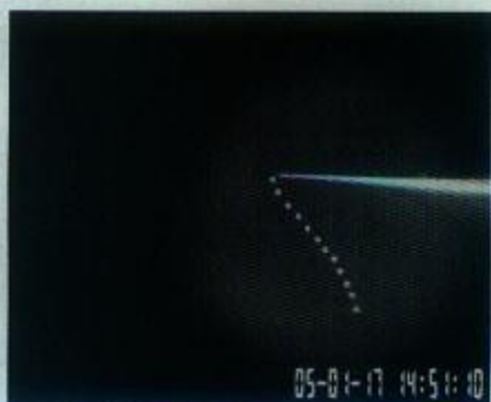
图2 液体喷射入不相混溶氛围液体的情形
