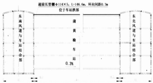
图2 蒲黄榆车站管棚布置纵断面图
