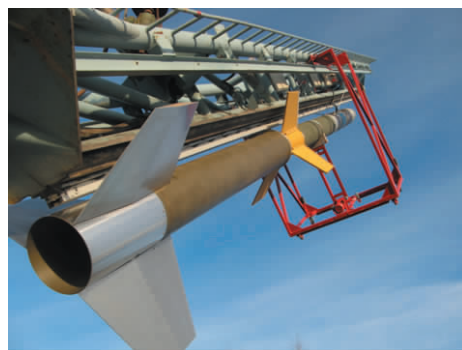
图 14 德国微重力材料物理实验火箭 MAPHEUS Fig. 14 German micro-gravity materials physics experiment rocket MAPHEUS
