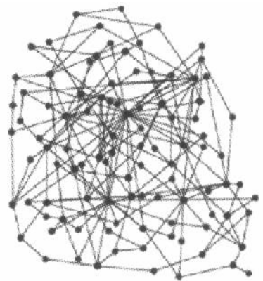
图2 一个无标度网络的例子, 包含100个节点, 由Barabási 和 Albert 提出的算法 [4] 所生成。注意到节点度大的节点数量很少, 绝大多数节点的节点度很小
