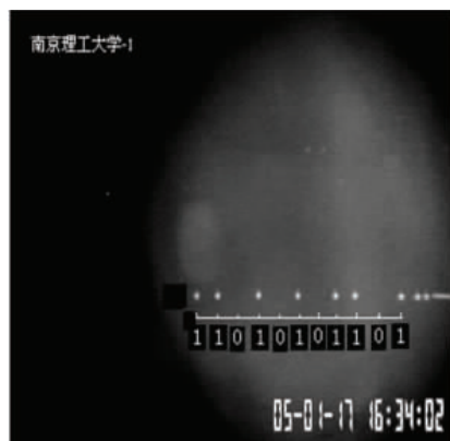
图5 液体按设定编码喷入匀速流动液氛形成的有节奏可控序列
