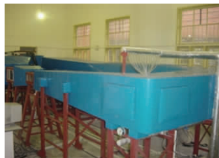
图 2 中国气动中心的 0.3 m×0.2 m 结冰风洞图
