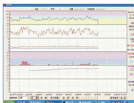
图 2 飞行员秦××(后舱)303×4 飞行过程中的心率、呼吸率、过载值、体动强度和体温的动态变化趋势图
