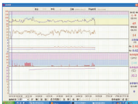
图 1 飞行员李×(前舱)303×4 飞行过程中的心率、呼吸率、过载值、体动强度和体温的动态变化趋势图
