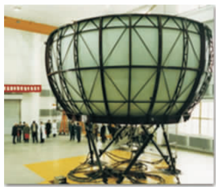
图 9 吉林大学开发的汽车动态模拟器 Fig. 9 Dynamic simulator of car developed by Jilin University
