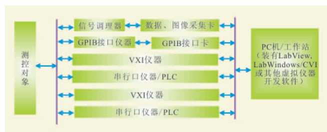
图 11 虚拟仪器构成框图
