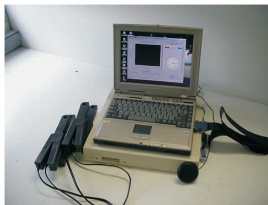
图 3 便携测量单元装置示意图
