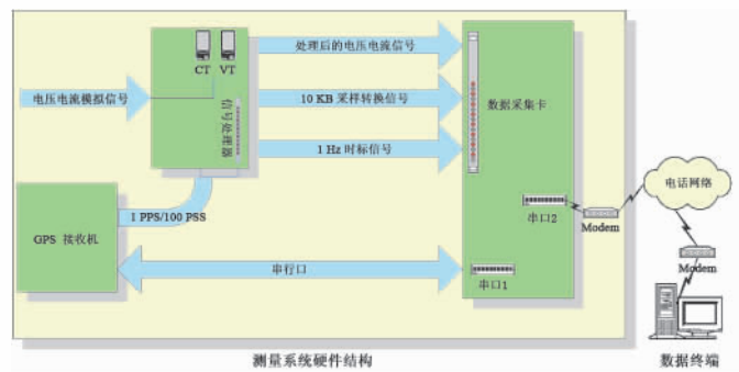
图 4 测量单元的内部硬件结构
