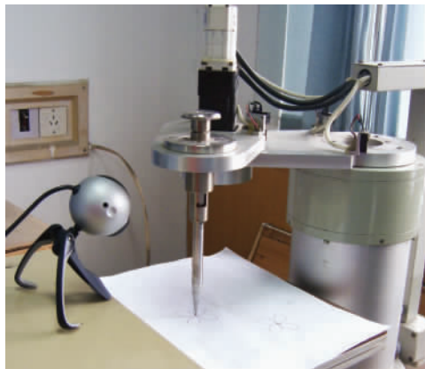
图 2 远程视觉控制系统本地装置实物
