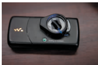
图3 手机改造的便携式 血液分析仪
