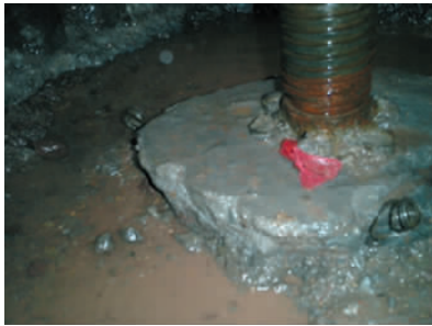
图 5 砼短柱抗拔摩阻力破坏
