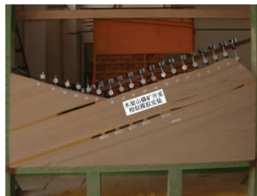
图 6 采空区上部大、小矿柱崩倒的模型
