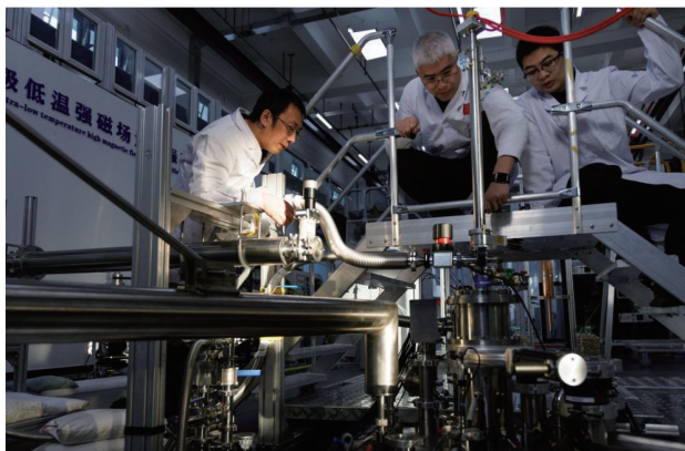
在位于怀柔综合极端条件实验装置的极低温强磁场量子振荡实验站内,实验人员讨论全超导用户磁体的运行情况
