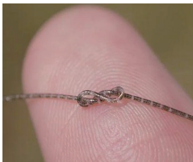
柔软的“纤维芯片”在手指上打结照片 (图片来源:复旦大学官网)
