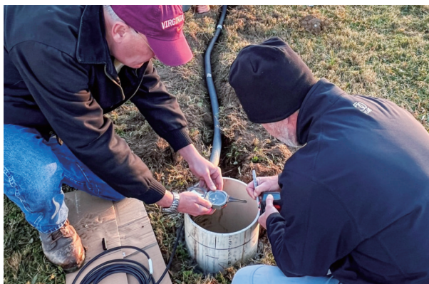
弗吉尼亚州的地震监测台站能够捕捉到为波托马克含水层回灌补水可能诱发的微小震动
