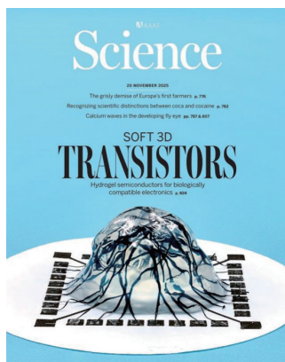
三维毫米级厚度的半导体水凝胶纤维,可用于构建与细胞交织的活体晶体管,从而模拟大脑中真实的神经元连接 (图片来源:《Science》封面)
