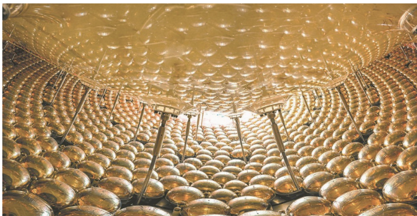
江门中微子实验中心探测器内部的有机玻璃球及光电倍增管 (图片来源:中国科学院高能物理研究所)
