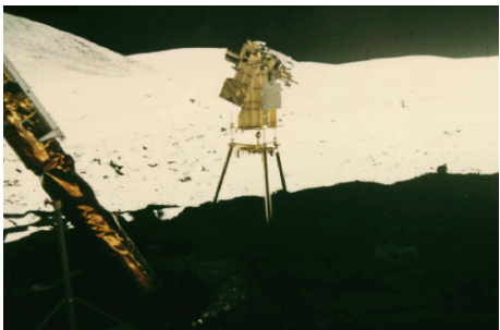
图 1 阿波罗 16 号任务携带的远紫外成像/摄谱相机
