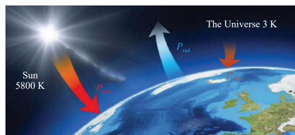
(a) 辐射制冷的基本原理
