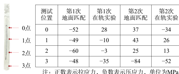
图10 样品应力检测位置及结果
