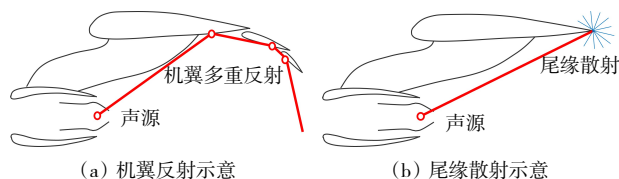
图 7 风扇后传安装噪声来源
