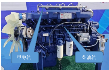
图9 采用双燃料喷嘴的甲醇压燃式发动机
