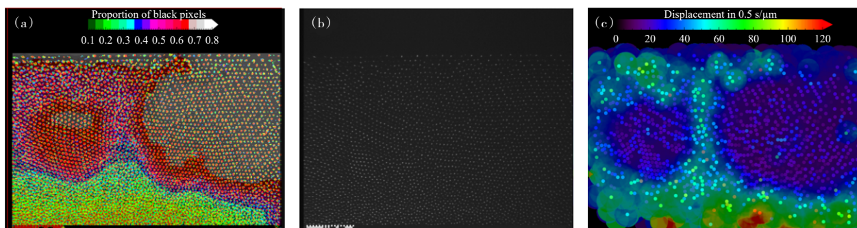
图 7 复杂等离子体熔化与再结晶实验中图片黑色像素比例(a)、实验原始图片(b)以及颗粒位移(c)
