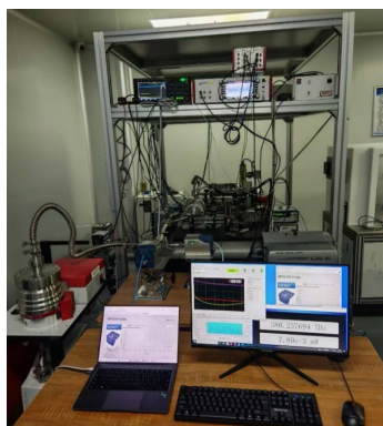
图23 光学干涉法真空测量装置实物
